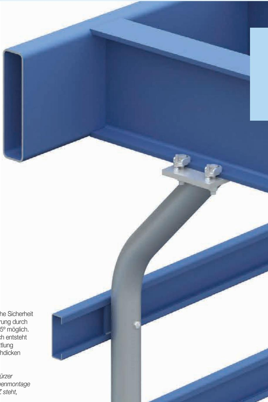
Klemme mit Stellschraube für stufenlosen Klemmbereich. Hohe Sicherheit durch Verdrehsicherung am Trägerflansch. Montageerleichterung durch Schraubenkopfaufnahme (Typ D2). Flanschneigungen bis zu 5° möglich. Einlegeteil zum Ausfüllen der Vertiefung beim Typ D2. Dadurch entsteht eine ebene Auflagefläche zum Anziehen der Mutter. Bei Ermittlung der Schraubenlänge das Maß T addieren. Für größere Flanschdicken Unterlegstücke wie beim Typ LR verwenden.
