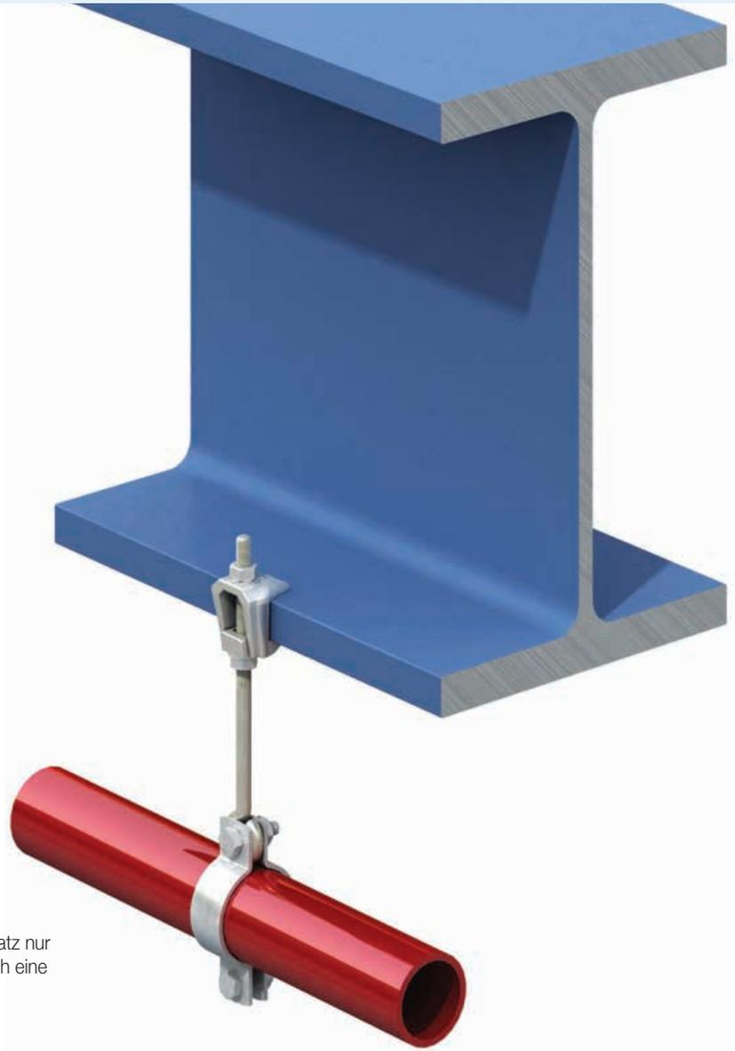
Zweiteilige Flanschklemme mit großem Klemmbereich. Einsatz nur an parallelen Flanschen. Die Schraube kann z. B. auch durch eine Gewindestange ersetzt werden.
