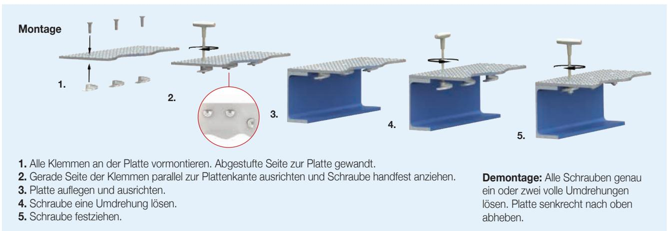
1. Alle Klemmen an der Platte vormontieren. Abgestufte Seite zur Platte gewandt.
